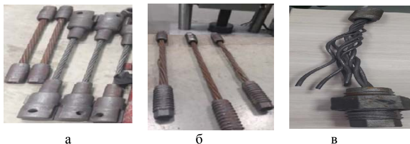
Рисунок 13 – Стендовые испытания канатных анкеров а, б – подготовленные для разрыва соответственно канатные и тросовые анкера; в – разорванный канатный анкер
