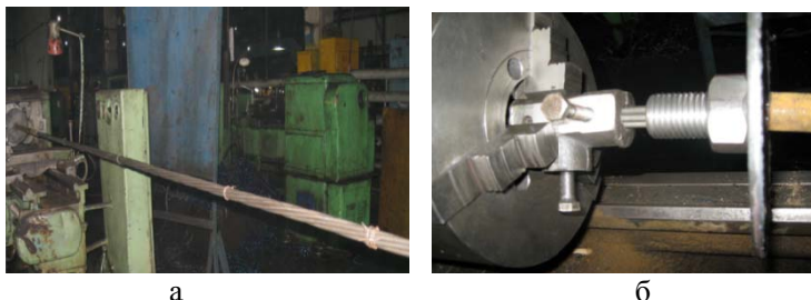
Рисунок 10 – Скручивание прутков проволок на смежно разнесенных станках а – общий вид станков; б – проволоки в патроне
