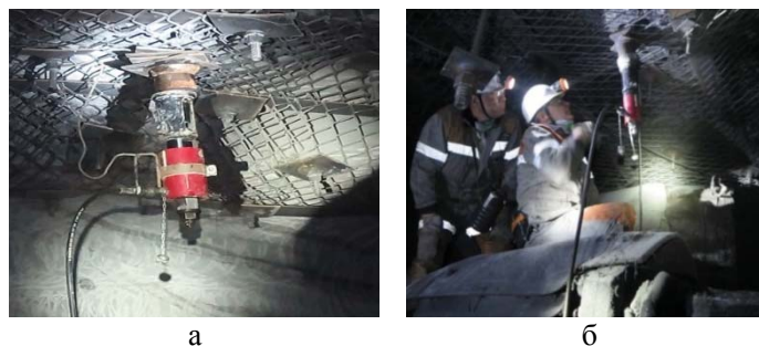
Рисунок 17 – Испытание несущей способности канатного анкера а – установка в рабочее состояние; б – испытание на выдергивание
