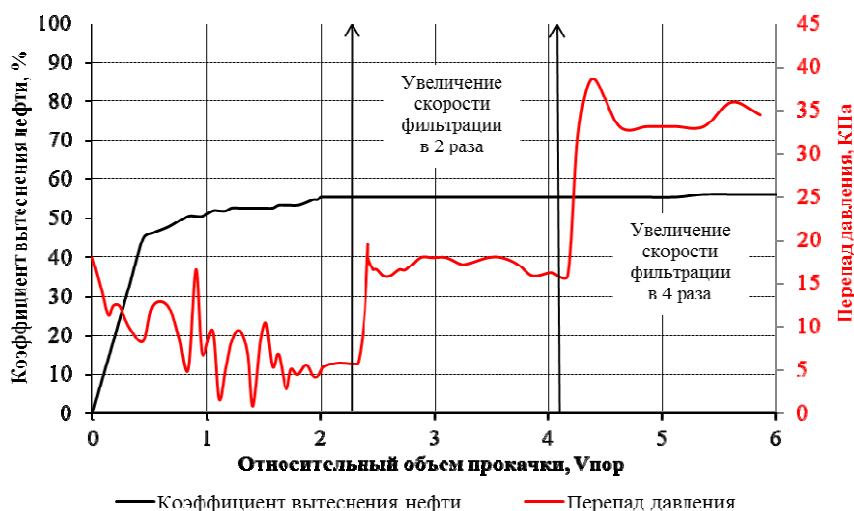
Рисунок 4 – Динамика коэффициента вытеснения нефти водой и перепада давления по составной керновой модели семилукской ( D_{3m} ) залежи Речицкого месторождения
