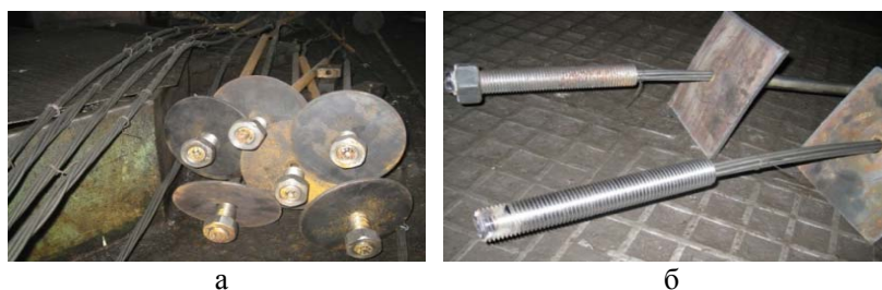
Рисунок 11 – Изготовленные опытные образцы канатных анкеров на ТОО «Карагандинский машиностроительный консорциум» а, б – виды соответственно с торца и сбоку
