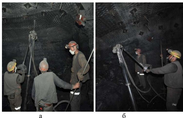
Рисунок 8 – Технология установки составных анкеров в условиях сопряжения конвейерного штрека 332к 12 -ю с вентиляционным уклоном к 10 шахты «Абайская» УД АО «АрселорМиттал Темиртау»
